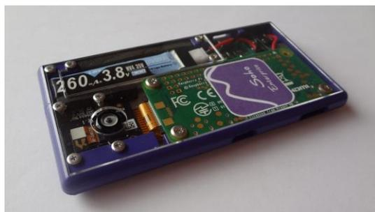
Raspberry Pi Zeroと組合せれば、超薄型でカスタマイズ可能なカメラができます。例えば、顔認識撮影する、首掛けライフログカメラ。
